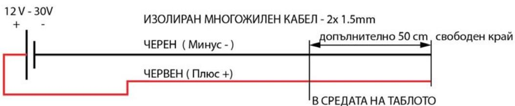
В схемата на захранване е задължително да се интегрира предпазител – 5A непосредствено след акумулатора.
